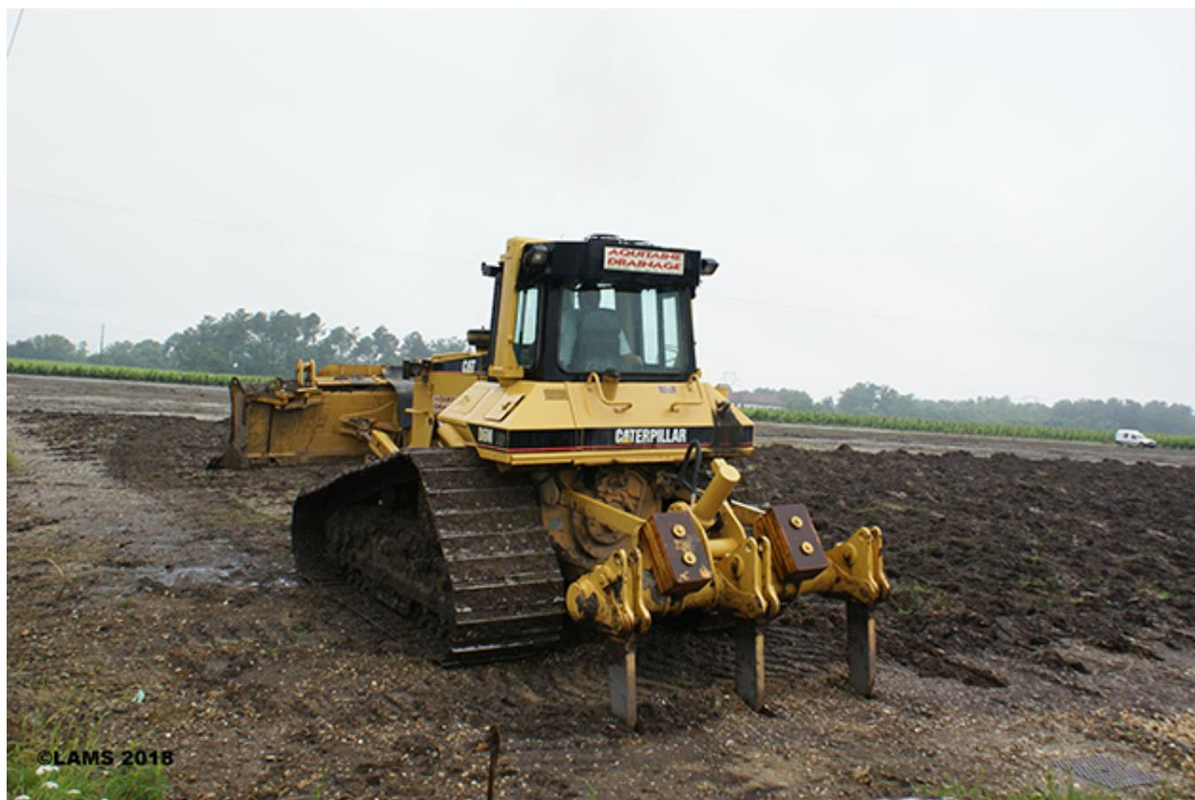
Défonçage d'un terrain avant plantation de vigne dans le bordelais. © LAMS 2018
