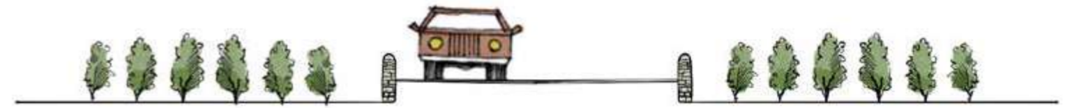
ROUTE SURÉLEVÉE AVEC DES DEMI-MURETS DE SOUTÈNEMENT
